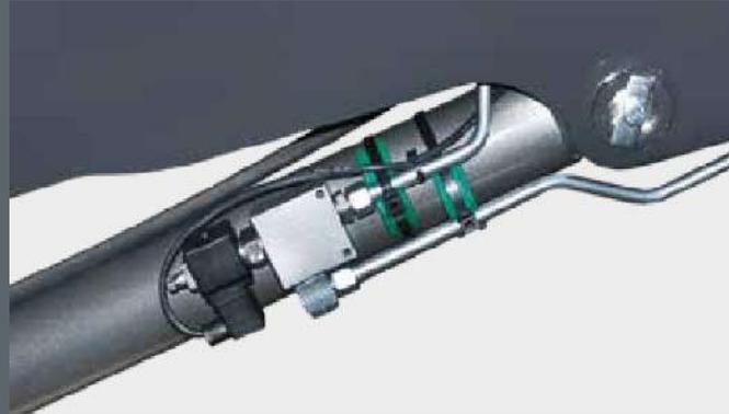
Система защиты от внезапного опускания груза
