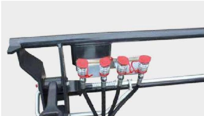
3-я и 4-я линия гидравлики (здесь с быстроразъемным соединением)
