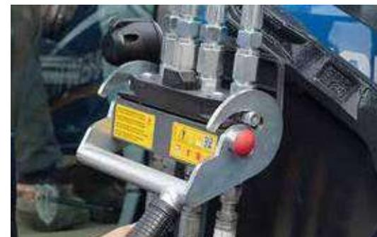
**2** Система Hydro-Fix позволяет одним движением подключить все гидрелинии к трактору. Погрузчик слегка приподнимается, чтобы зафиксировать фиксатор в крюке направляющей.
