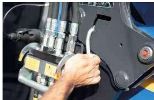
**3** Путем опускания запирающего рычага погрузчик надежно фиксируется в монтажном элементе. После этого еще немного приподнимите погрузчик.
